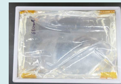
放射線保護容器の側面部のポリカ製ブロック(水バッグ収納状態)
