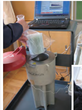
(左、下) 給食に使用するものと同じ検査用の食材を刻んで計測器にかけています。(福島県提供)
