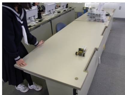
各ロボットカーの、床のタイル1枚を走行するためにかかる秒数、90度方向転換するのにかかる秒数等の個体特性に関わるデータを取得する。
