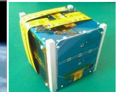
ベトナム宇宙機関と東大開発による超小型衛星 (10*10*10cm のサイズ)
