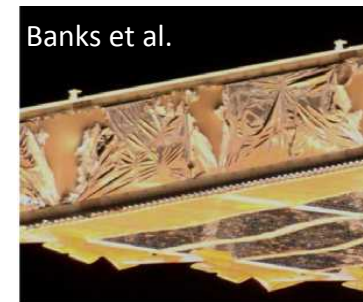
アルミニウム蒸着した単層ポリイミドフィルムが原子状酸素の影響を受けて破断（1年間の曝露後。ISSでの先行実験）
