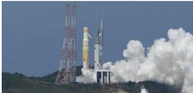
第1段実機型タンクステージ燃焼試験 (CFT)
