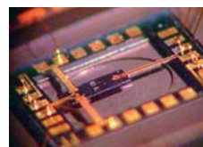
MEMSデバイスを応用した複合気体センサー
