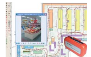
小型携帯センサー(右下)を用いた動線調査・管理システム
