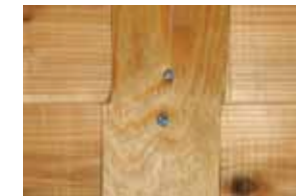
面内せん断試験時の合板の変形
