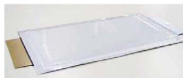
試作した小型ラミネート型電池（100 \mu m）
