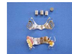
義歯床(入れ歯)用のコバルト合金材料(上)と義歯床の試作品(中、下)
