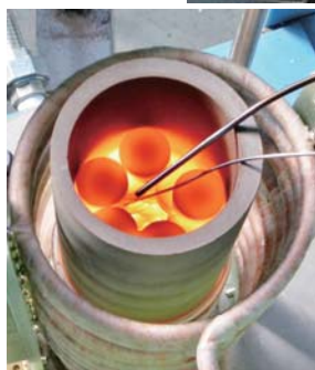
高温過熱水蒸気発生装置(炉体部)
