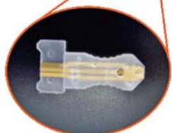
1. 血液中のアミノ酸を測定する酵素チップ 及び電気化学的測定装置
