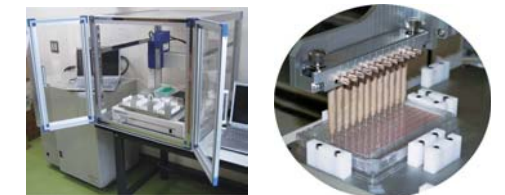
磁気移動型平板反応法を応用したcDNA合成装置
