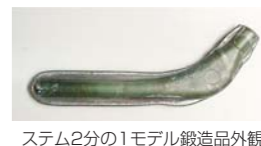
ステム2分の1モデル鍛造品外観
