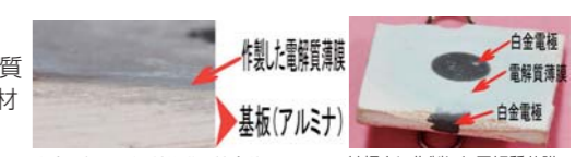
白金電極と電解質薄膜の接合体 基板上に作製した電解質薄膜
