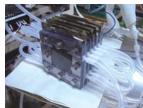
Ni-PTFE複合粒子成形体を用いたスタック試作品
