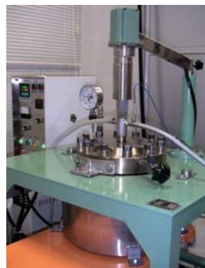
高温高圧の実機環境を模擬した環境模擬試験機
