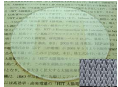
反射防止構造 (パターン部50mm×50mm:三洋電機製)
