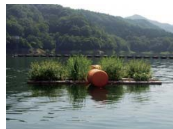
浮島型のダム湖への設置
