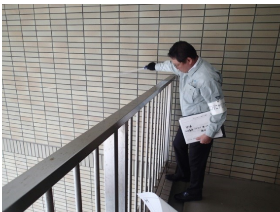
写真 タイル壁の打診
