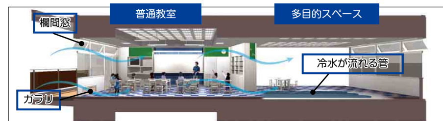
図 22-2 欄間窓・ガラリを利用した自然通風と床涼房の活用（東京都武蔵野市立大野田小学校）
